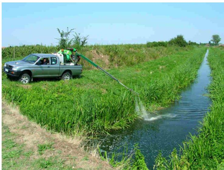
Sia i nebulizzatori che le motopompe sono corredati da una pompa autoadescente che consente il rifornimento idrico direttamente dai corsi d'acqua.
